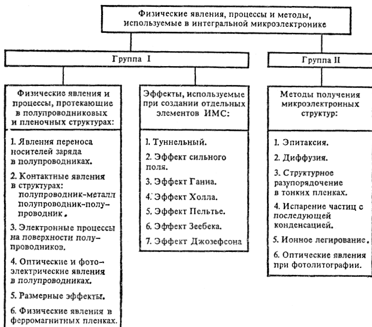
Рис. 2.1. Физические явления, процессы и методы, используемые в интегральной микроэлектронике
