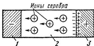
Рис. 8.25. Принцип работы ионистора:
